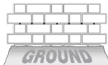
Расположение отверстий при сверлении двойной крестовой кладки
